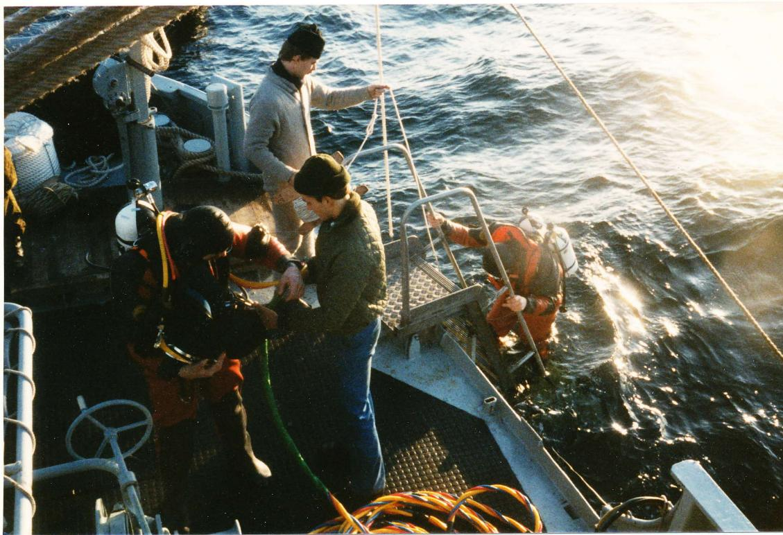
En svømmedykker ses på vej ned ad skibets lejder et sted i Agersø Sund på 25 meter vand. 25 meter er den største dybde vi med svømmedykkerudstyr skal ned på, idet større dybde kræver radio-kommunikation og ikke blot LivLine - signal - kommunikation.
