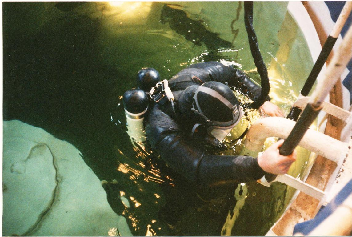
Slangedykker på vej ned i øvelsestanken for at løse en række små-opgaver. Bemærk dykkerens umbilical, der indeholder luftslange (9 bar), telefonkabel, livline og pneumoslange (dybdemåler).
